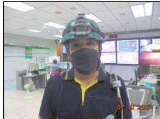
ภาพที่ 3.101 การตรวจวัดระดับเสียงที่พนักงาน สัมผัสบริเวณอาคารหม้อบดซีเมนต์ 1-3
