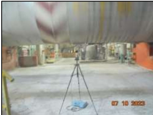
ภาพที่ 3.98 การตรวจวัดระดับเสียงบริเวณอาคาร หม้อบดซีเมนต์ 1
