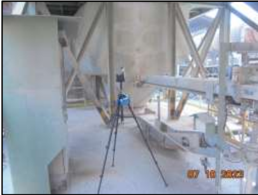
ภาพที่ 3.84 การตรวจวัดปริมาณฝุ่น (TD) บริเวณ Chloride bypass plant
