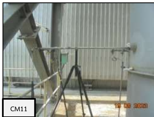
ภาพที่ 3.19 (ต่อ) การตรวจวัดคุณภาพอากาศจากปล่องหม้ออบซีเมนต์ 1-11
