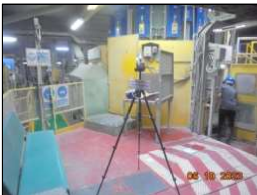
ภาพที่ 3.83 การตรวจวัดปริมาณฝุ่น (TD) บริเวณอาคารบรรจุซีเมนต์ 3
