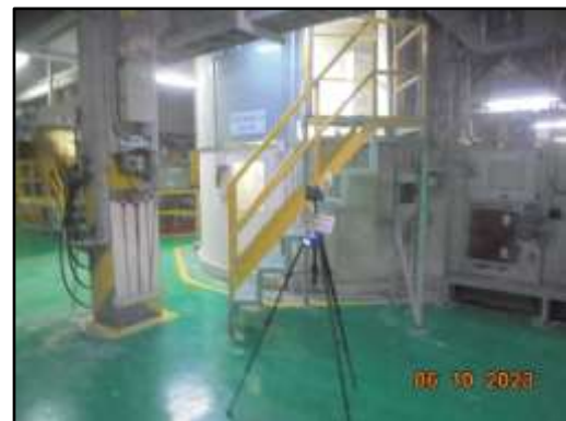
ภาพที่ 3.83 การตรวจวัดปริมาณฝุ่น (TD) บริเวณอาคารบรรจุซีเมนต์ 3
