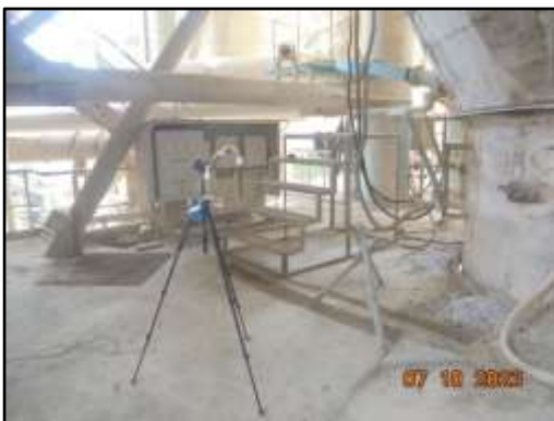
ภาพที่ 3.86 การตรวจวัดปริมาณฝุ่น (TD) บริเวณ AFR K6
