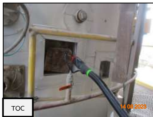
ภาพที่ 3.17 การตรวจวัดคุณภาพอากาศจากปล่องหม้อเผา 5
