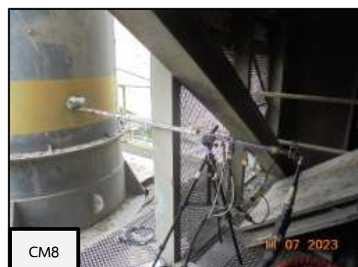
ภาพที่ 3.19 การตรวจวัดคุณภาพอากาศจากปล่องหม้อบดซีเมนต์ 1-11
