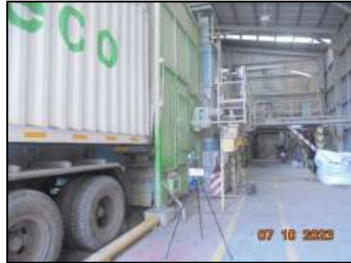
ภาพที่ 3.85 การตรวจวัดปริมาณฝุ่น (TD) บริเวณจุดป้อน RDF
