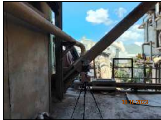
ภาพที่ 3.112 การตรวจวัดความร้อนในสถานที่ทำงานบริเวณหม้อเผา 6
