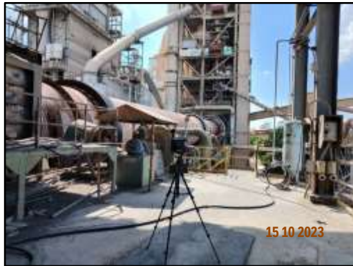
ภาพที่ 3.112 การตรวจวัดความร้อนในสถานที่ทำงานบริเวณหม้อเผา 6
